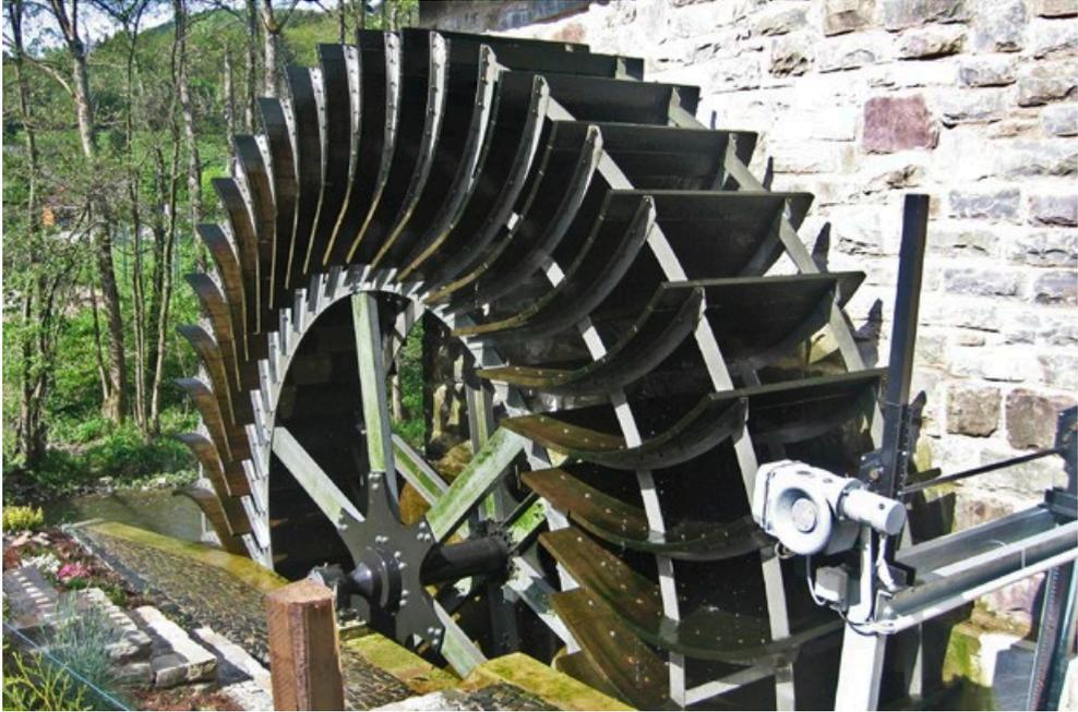
Zuppinger-Wasserrad bei Lennestadt im Sauerland. Das Zuppinger-Rad ist ein Wasserrad mit speziell gekrümmten Schaufeln, die nicht nur den hydrostatischen, sondern auch den dynamischen Druck des Wassers ausnutzen und dadurch einen höheren Wirkungsgrad erreichen.
