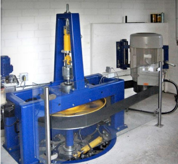
Eine Kaplan-Turbine mit Riementrieb und Generator im Bergischen Land. Bei der Kaplan-Turbine wird der Generator über einen Hochleistungs-Flachriemen angetrieben.
